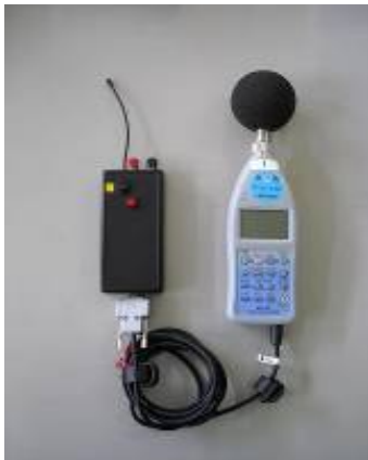
無線送信機 (騒音計および振動計を接続)
