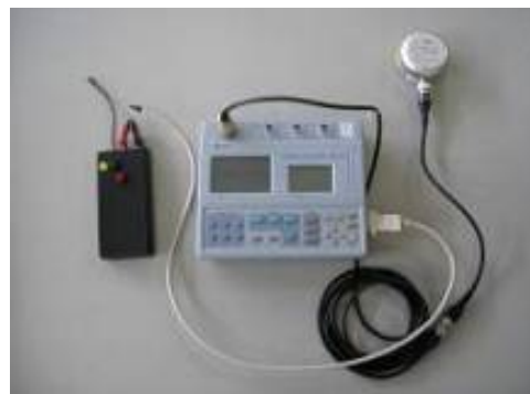
無線送信機 (騒音計および振動計を接続)
